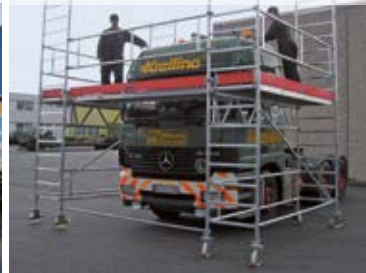
Konstrukcja jezdna z rusztowań
