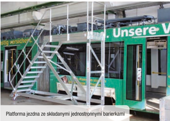
Platforma z regulacją wysokości i rozkładanymi barierkami
