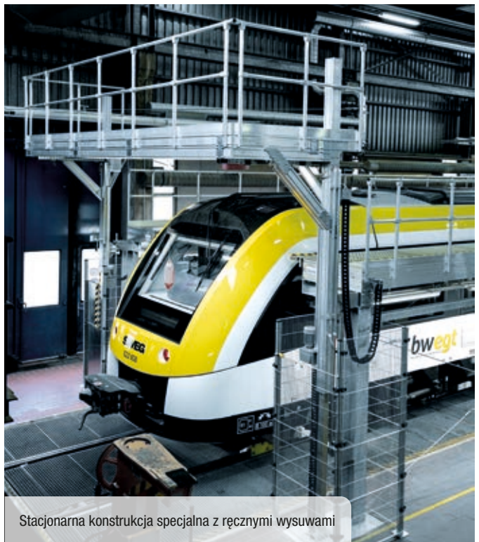
Platforma wysuwana z listwą odbojnikową i składanymi barierkami
