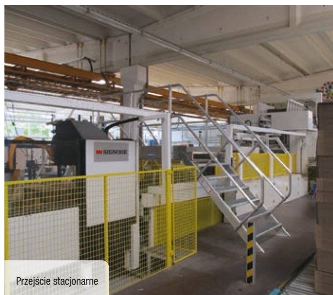
Platforma jezdna ułatwiająca dostęp do urządzenia
