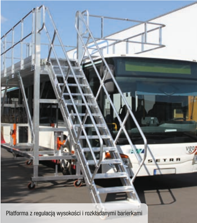
Platforma montażowa jezdna ze składanymi barierkami
