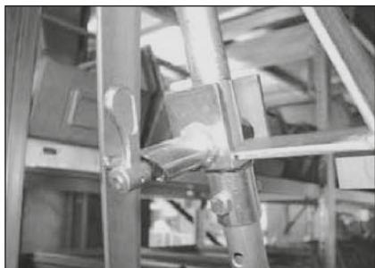
Lazítson a rögzítésen (a meglazított rögzítés a lenti képen látható).
