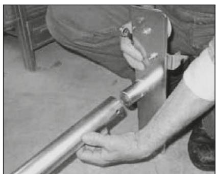
Zamocować prowadnicę boczną przy pomocy śruby z łączem sześciokątnym, podkładki i nakrętki zabezpieczającej.
