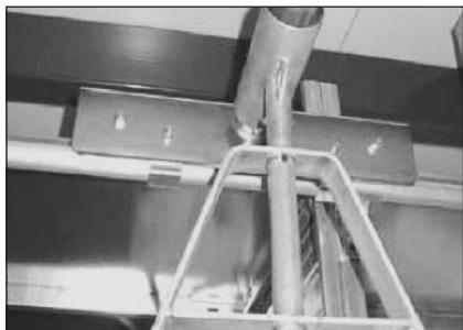
Heben Sie das Leiterteil an. Durch das Drehen um 90 Grad wird die RegalLeiter in dieser Position durch den Querstift gehalten.
