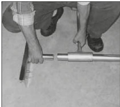
Schieben Sie das Kopffahrwerk über das Querrohr. Die lose Seitenführung in das Querrohr. Das Spiel zwischen loser Seitenführung und Querrohr muss ca. 20 mm betragen.
