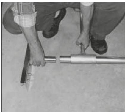
A futószerkezetet tolja a keresztirányú csőre, a laza oldalsó vezetőt pedig a keresztirányú csőbe. A laza oldalsó vezető és a keresztirányú cső közti holtjáték kb. 20 mm legyen.
